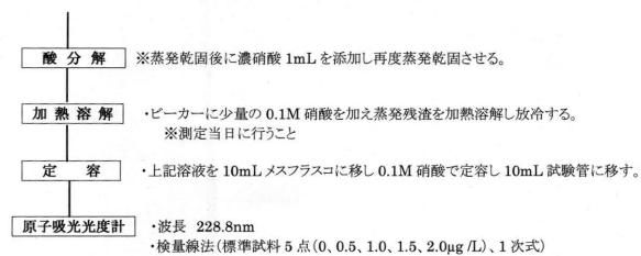
・検量線法(標準試料 5 点(0、0.5、1.0、1.5、2.0μg/L)、1 次式) ※グラファイトファーネス原子吸光法で測定 試料溶液 20μL に対して硝酸パラジウム修飾剤 4μL を添加(注入容量 24μL)
