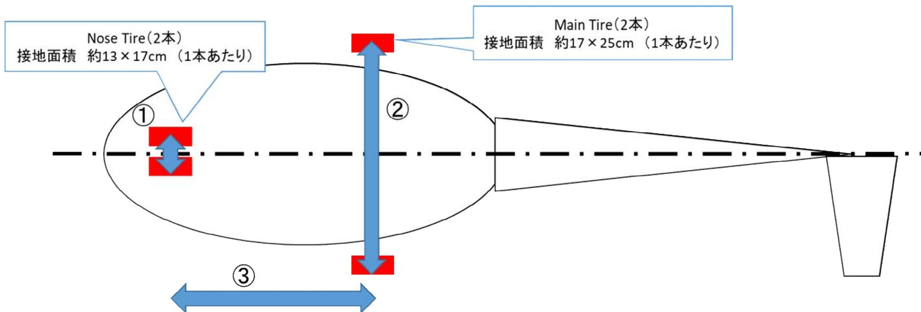
機体：最大重量11トン 全長：19.5m 全高：約5m マイローター直径：16.2m 機体：最大重量11トン
