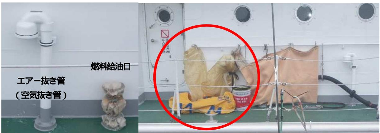
エア－抜き管にオーバーフロータンクを設置した状況
