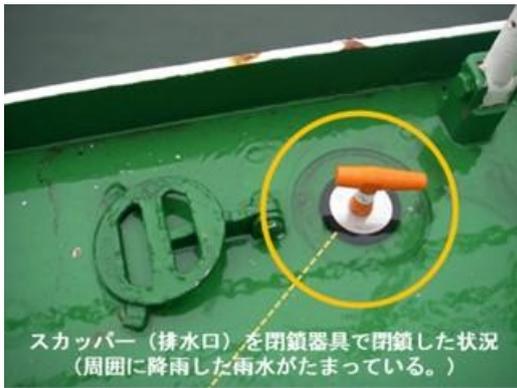
スカッパ- (排水口) を閉鎖器具で閉鎖した状況 (周囲に降雨した雨水がたまっている。)
