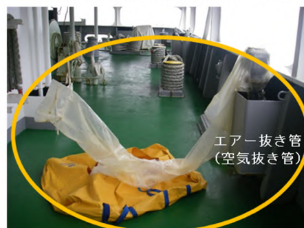
エア抜き管（空気抜き管）にオーバーフロータンクを設置した状況
