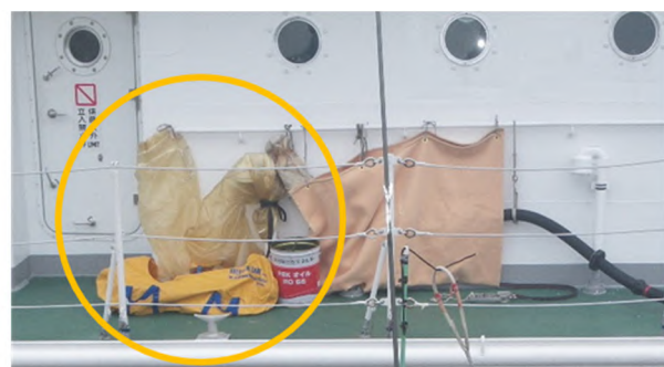
エア抜き管（空気抜き管）にオーバーフロータンクを設置した状況
