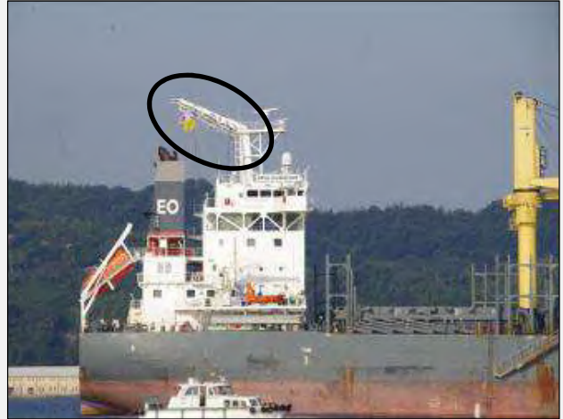
橋と衝突した衝撃で曲がったマストの様子
