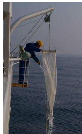
プランクトンネット （ノルパックネット（動物プランクトン））
