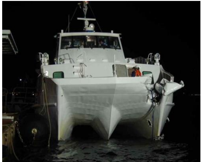
写真4 衝突によって損傷した旅客船
