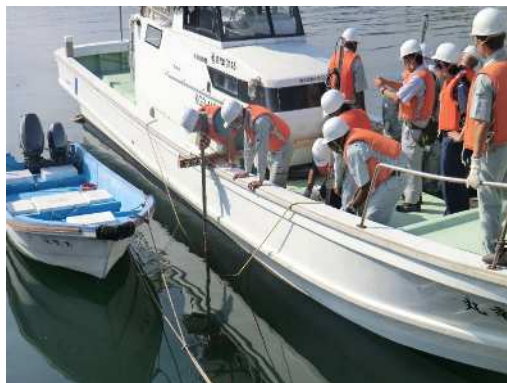
測深準備 (観測機器の船への取付け作業)
