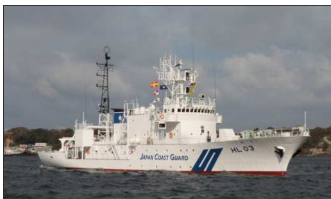
明洋 総トン数 550トン 全長 60.0メートル 幅 10.5メートル
