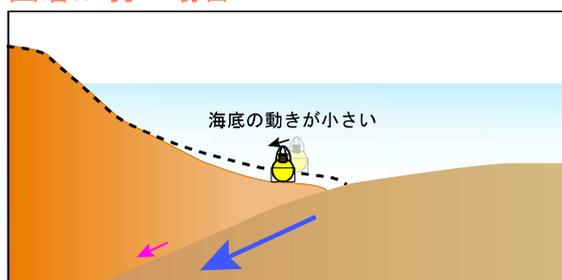
南海トラフでは、海のプレートが陸のプレートの下に沈み込んでいます。その際、海と陸のプレートの境界が強く固着していれば、陸のプレートは引きずり込まれ、地震を起こすエネルギーが蓄積されます。この固着の強弱の分布は、震源域周辺のプレートの動きを調べる「地殻変動観測」によって推定できます。海溝型地震では、震源域の大半が海域にあり、かつトラフ軸近くの海底が巨大津波の発生域と考えられているため、陸上の観測のみからでは地震及び津波の規模を高い精度で評価することは困難です。そこで、海底において地殻変動観測を実施することで、より詳細な固着分布の把握が可能となり、海溝型巨大地震の震源域の推定や発生メカニズムの解明に貢献できます。
