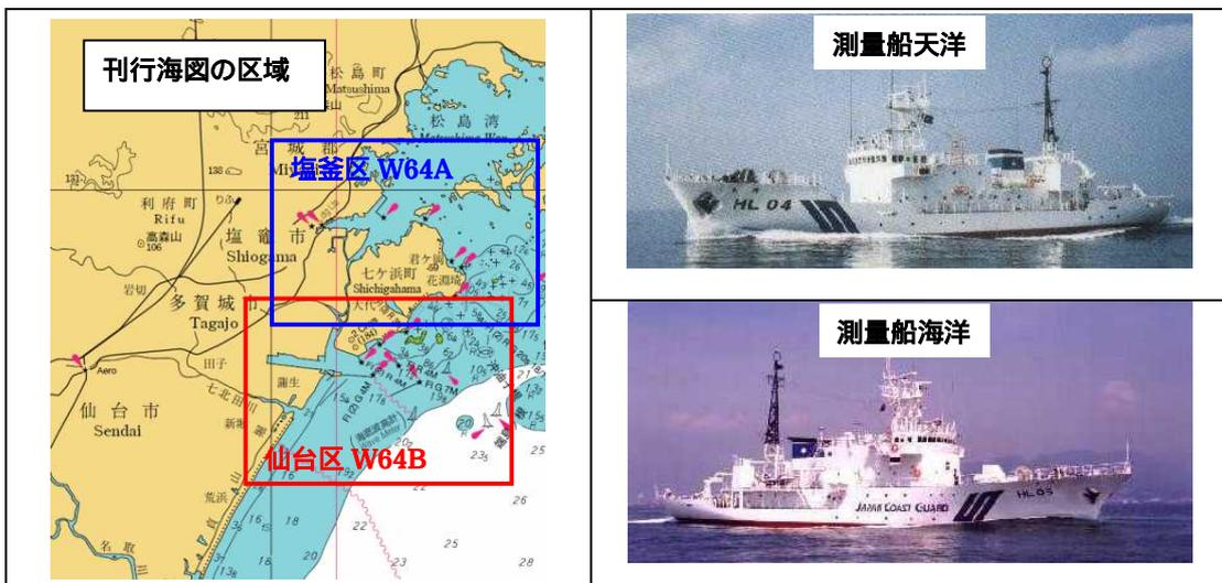
2. 今回の水深測量では、航路及び主要な岸壁付近を優先して実施しました。この測量成果について、地震前の測量成果と見分けられるようにするため、新たに海図に精度索引図を掲載しました。精度索引図では、地震発生後に実施した測量区域を水色で塗りつぶし、水深測量の精度情報（A1）を付記するとともに、海図本図では同区域の境界を赤色点線で明示しています。
