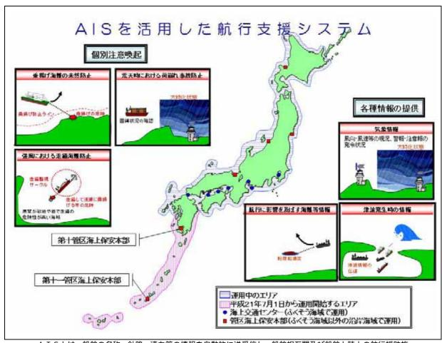
AISとは、船舶の名称、針路、速力等の情報を自動的に送受信し、船舶相互間及び船舶と陸上の航行援助施設との間で情報の交換を行うシステムで、国際航海に従事する300トン以上の船舶(旅客船は全て)及び国際航海に従事しない500トン以上の船舶に対して、平成20年7月1日までに搭載することが義務付けられました。
