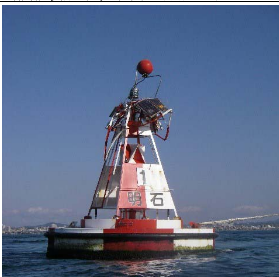
「明石海峡航路中央第一号灯浮標（神戸）」 衝撃で灯浮標と錘をつなぐ鎖が切れ一時漂流
