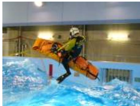
横浜海上防災基地プールにおける検証。浮力試験(左)と波浪中吊り上げ試験(右)。
