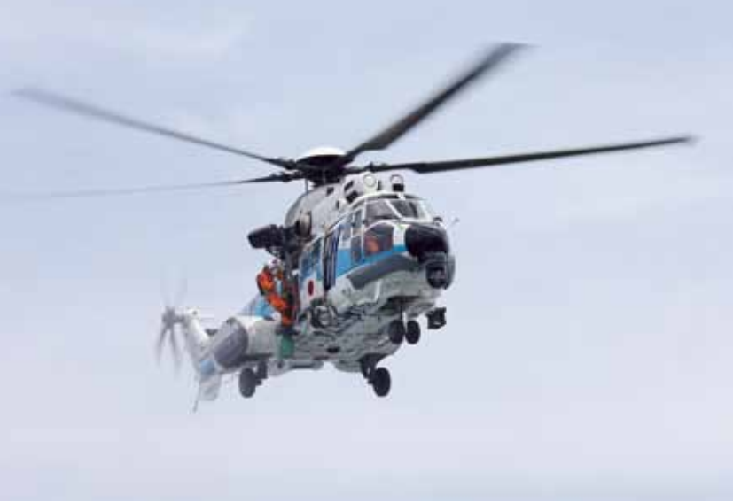
スーパーピューマ225と機動救難士によるリベリング降下。機動救難士はロープ1本で18~30m下の目標へ向けて自力降下する。ヘリコプターの整備士も同乗しホイスト要員として救助をサポート。
