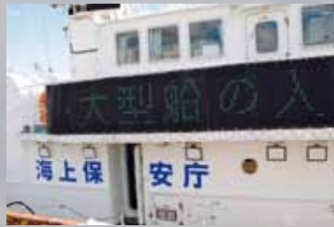
船橋側面に掲示される停船命令等表示装置で周囲の船に注意を促す。表示する文言は船内のパソコンでその場で変更・作成可能だ。
