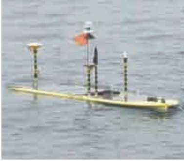
海上保安庁が導入した自律型海洋観測装置 AOV (Autonomous Ocean Vehicle)。浮体は、3メートルほどの長さで、遠隔操作または事前に設定したルートに従い移動し、自動で気象・海象の観測を行う。AIS受信機を備えており、接近する船舶を避け、接触を回避する機能を有している。
