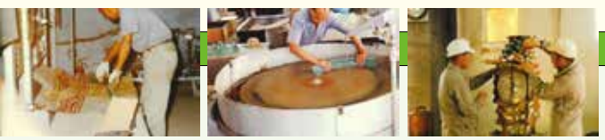
フレネルレンズのプリズム製作の様子
