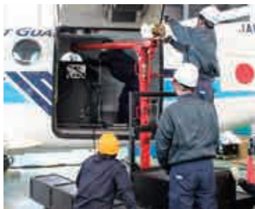
貨物扉より専用器具を用いた 測深機搭載作業
