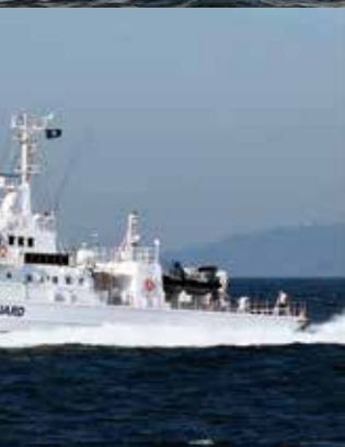
PC型 (30メートル型) 巡視艇たかつき 全長：32.0メートル 最大幅：6.5メートル 総トン数：100トン
